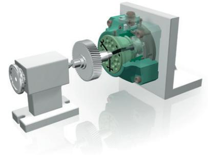
Bearbeitung von langen Teilen, beispielsweise mithilfe eines Reitstocks zur Abstützung.
