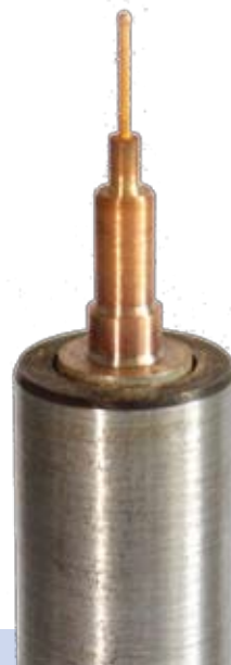
■ Kalottenelektrode (ABS-Bauteil) mit einem Kugeldurchmesser an der Spitze von 1,2mm und einer Toleranz von -5\mu\text{m} .
