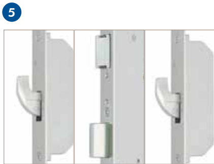
5 Riegelhakenschloss 3-fach mit 2 Schwenkhaken und einem Hauptriegel
