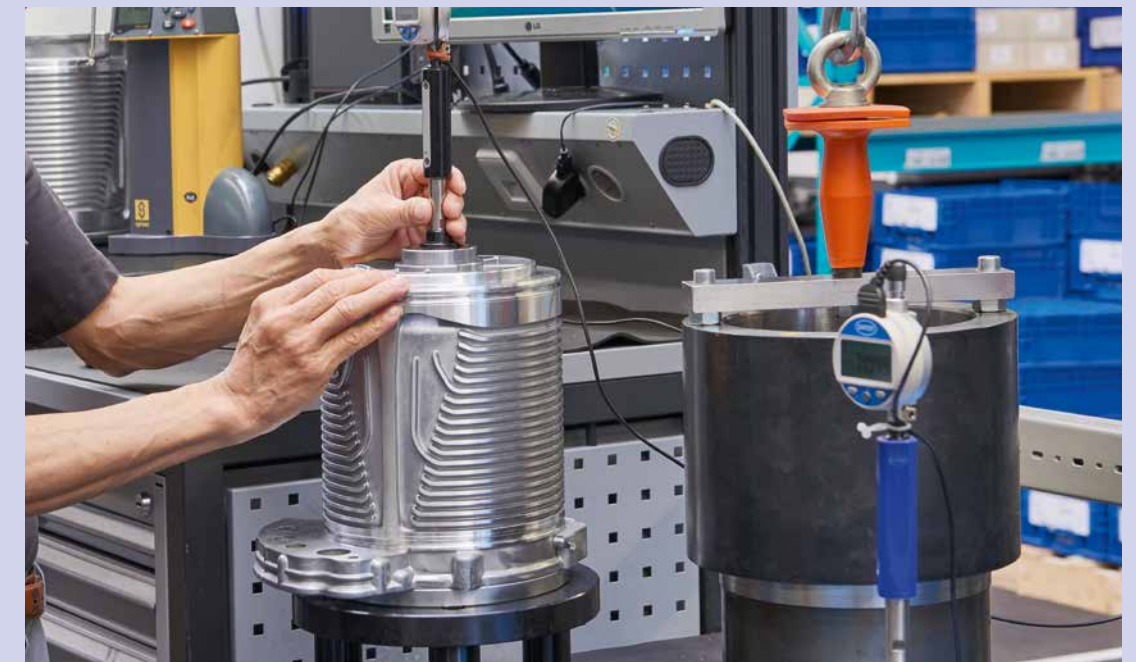
Präzise muss es zugehen, wenn bei der Rees Zerspanungstechnik GmbH Statorgehäuse für den elektrischen Antrieb von modernen Volvo-SUVs gefertigt werden. Präzise Maßhaltigkeit entscheidet über die Langlebigkeit des E-Antriebs.
